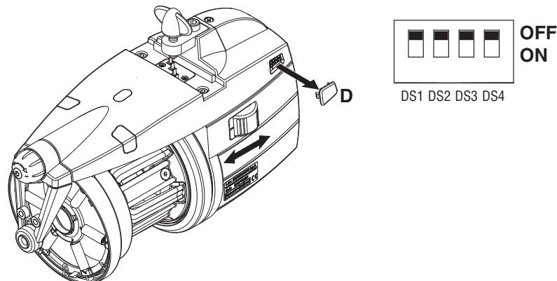
**注意:** 要激活预置的每一个双列直插式开关的功能，必须使用**0-1**转换器关掉导纱器；然后将双列直插式开关置于所需的位置并开启导纱器。
