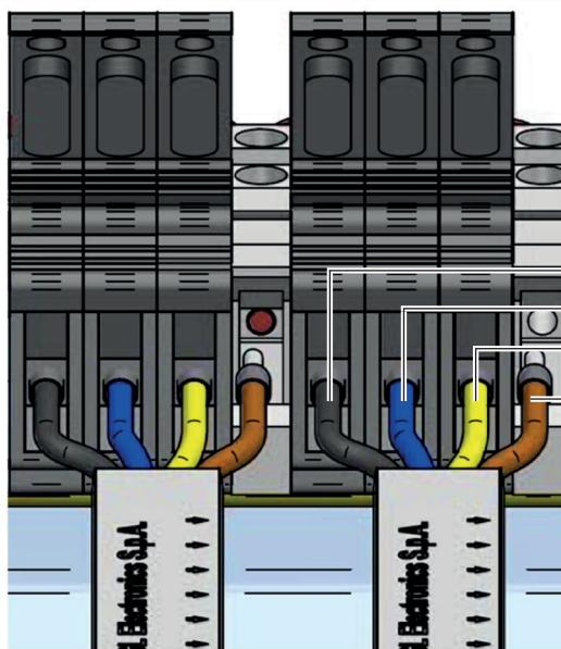
确保通过正确的颜色序列，将扁平电缆连接到变压器
