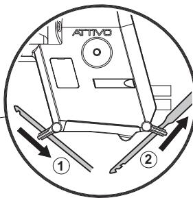
为了不损害 **TWM**, 建议使用具良好状态的没有堆积纱线在末端的提取器。给导纱器穿纱绝不能使用钢针, 因会对 **TWM** 产生损害。
