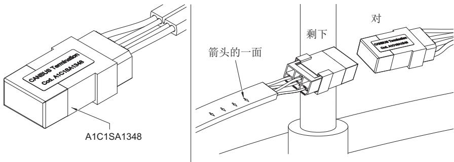
CAN通过电缆上的电阻而终止，故所有馈线上的DS4必须关闭 (**OFF**)。
