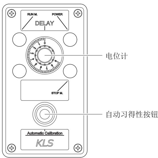
电位计：机器设定的从闲置状态到达工作速度所需的时间。将数值设定为3秒
